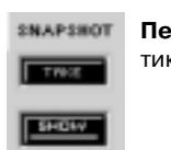
**Переключатели Snapshot.** Данная функция позволяет создать моментальный снимок кривой частотной характеристики сигнала (нажатие кнопки Take) и показать ее на экране (нажатие кнопки Show).
