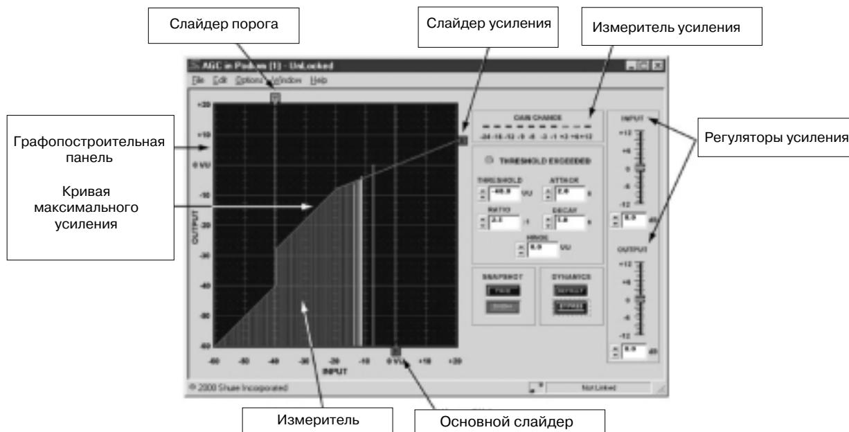
**Измеритель графопостроительной панели.** В режиме Live Mode данный измеритель отображает уровень входного и относительного выходного сигналов. Измеритель позволяет осуществлять визуальный контроль за воздействием процессора на текущий программный материал. Функция измерителя может быть отключена или включена выбором Options>Transfer Curve Meter в меню. Установка по умолчанию: измеритель включен.
